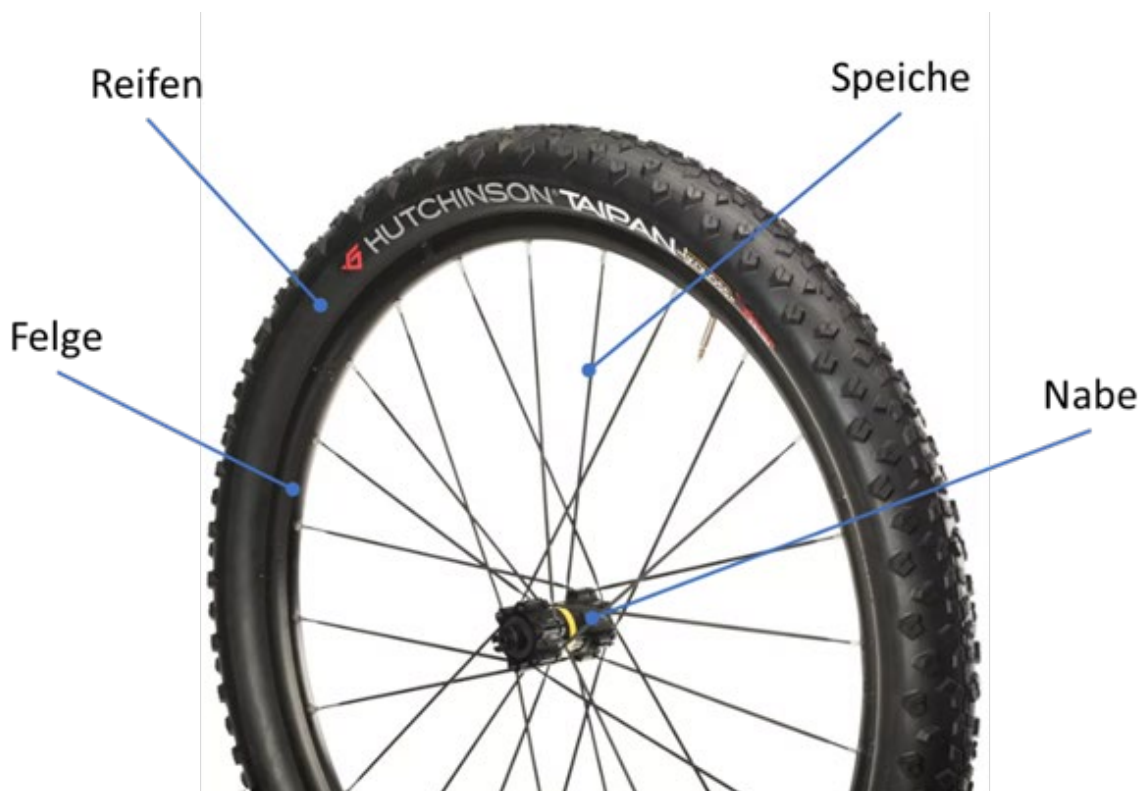
Abbildung 6 : Einzelteile eines Zugspeichen-Laufrads mit Reifen [8]
