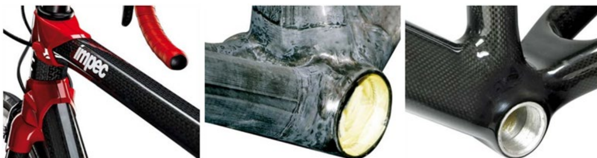
Abbildung 5 Fahrradrahmen in Muffenbauweise (links), Tube-to-Tube-Bauweise (mitte) und Mono-coque-Bauweise (rechts) [6, S. 180-181]
