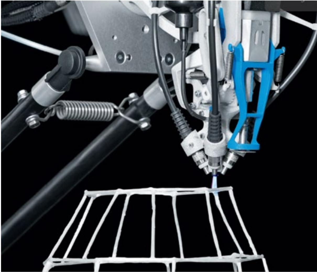
Abbildung 6 3D Cocooner der Fa. Fest [FRO16]. Zu sehen ist der Tripod als Handlungssystem und die angebrachte Seidendrüse, durch die das Material frei im Raum gespritzt wird
