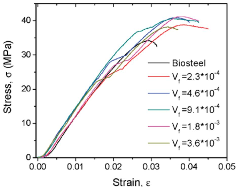
Abbildung 5 Spannungs-Dehnungsdiagramm für Lösungen mit unterschiedlichen Nanoröhrenmassenanteilen. Auf der x-Achse ist die Bruchdehnung, auf der y-Achse ist die Belastung, also die aufgebrachte Kraft im Verhältnis zur Querschnittsfläche der unbelasteten Probe aufgetragen. Ein Volumenanteil der Nanoröhren ( $V_f$ ) erreicht bei  $V_f = 2,3 \cdot 10^{-4}$  die größte Bruchdehnung [BLO07]
