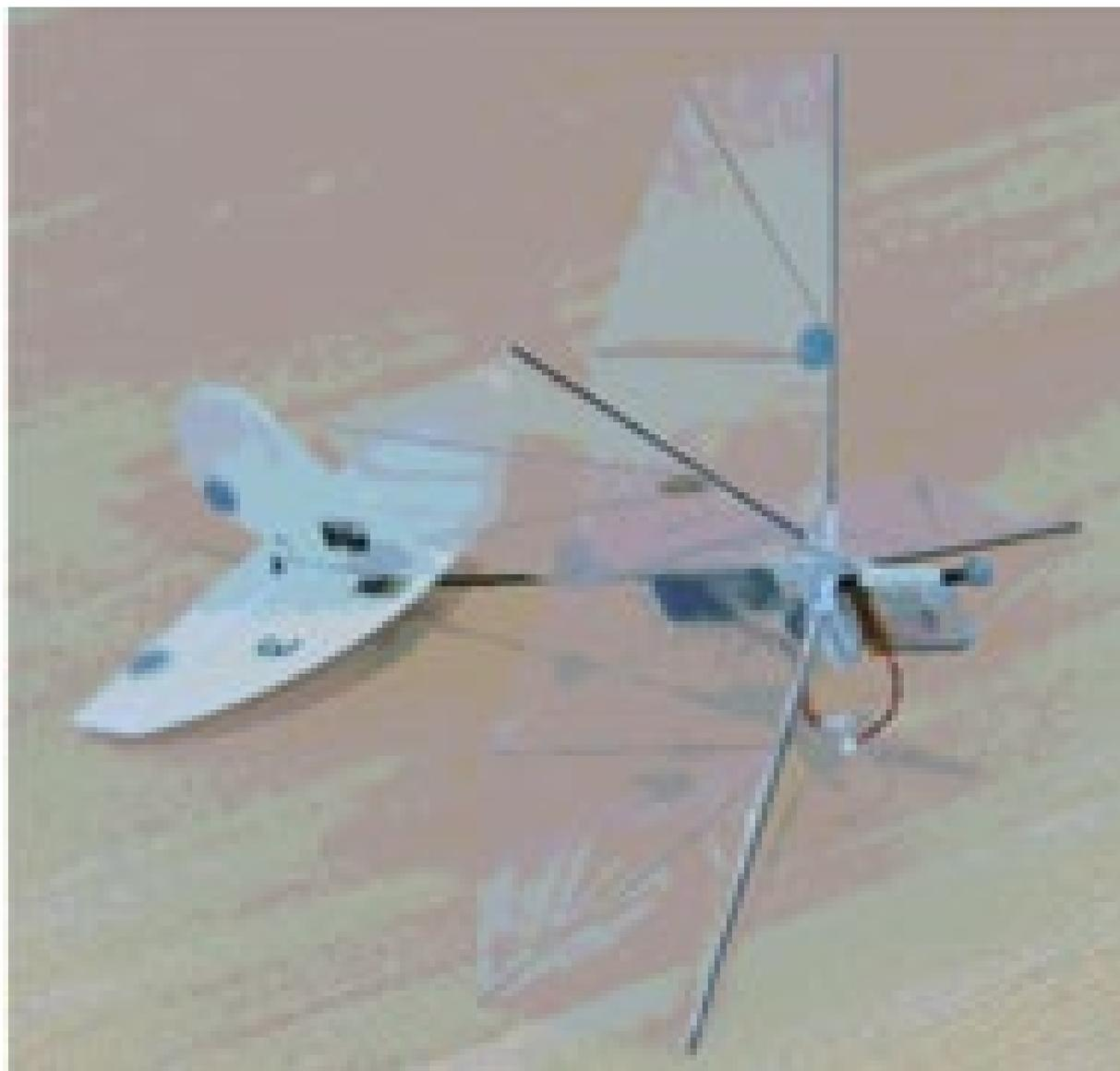
Abbildung 14 Flapping-Wing Mikrodrohne aus den Niederlanden [ARM16]
